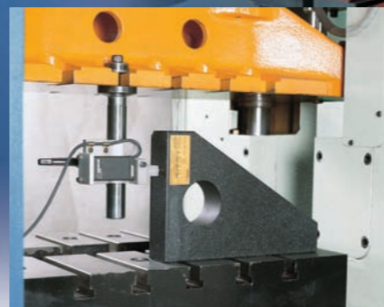
Computerized squ areness test 電腦偵測垂直度
